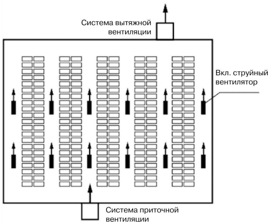
Рисунок 5.2 – Вентиляционная система автостоянки в штатном режиме
