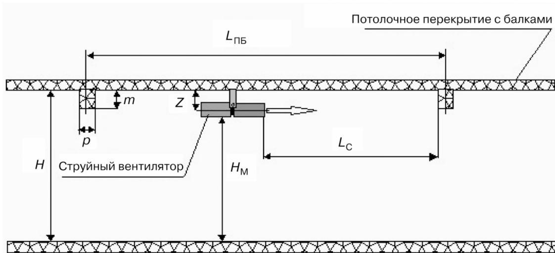
Рисунок 5.4 – Схема расположения струйного вентилятора под потолочным перекрытием
