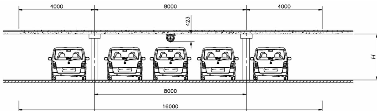
Рисунок 5.7 – Расположение струйных вентиляторов над парковочными местами
