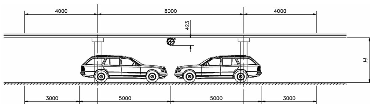
Рисунок 5.8 – Расположение струйных вентиляторов над парковочными местами
