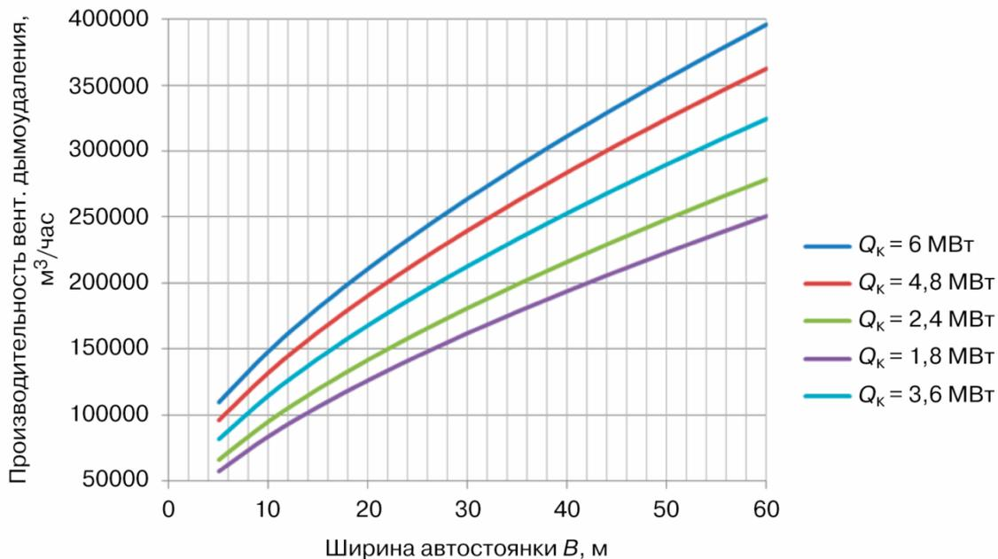
Рисунок 6.4 – Зависимость производительности вентилятора дымоудаления от габаритного размера  $B$  автостоянки при  $Fr = 4,5$
