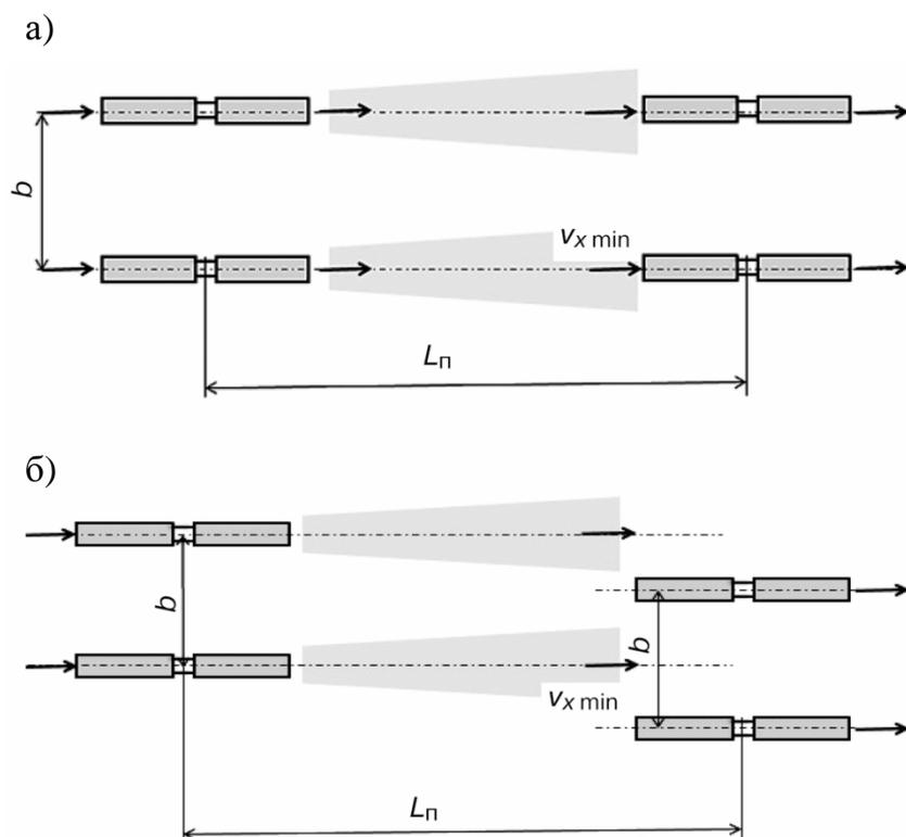
а) – соосная установка струйных вентиляторов; б) – параллельная установка струйных вентиляторов
